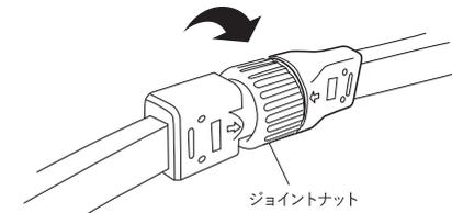
ジョイントナットを右方向に回してしっかりと締め付けてください。
