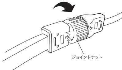
ジョイントナットを右方向に回して、回らなくなるまで締め付けてください。
