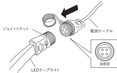
LEDテープライトと電源ケーブルを接続部の形状に合わせてはめ込みます。
